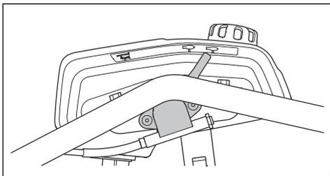
2. Inclinare il prodotto in avanti fino a quando le ruote sull'impugnatura non poggiano a terra.
