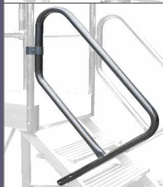
**Parapetto frontale e parapetto laterale** dotati di mancorrente alto mt. 1,10 e corrente intermedio realizzati in robusto profilo tondo Ø 42 mm. e provvisti di fermapièe alto 150 mm. in conformità a norme europee EN131
