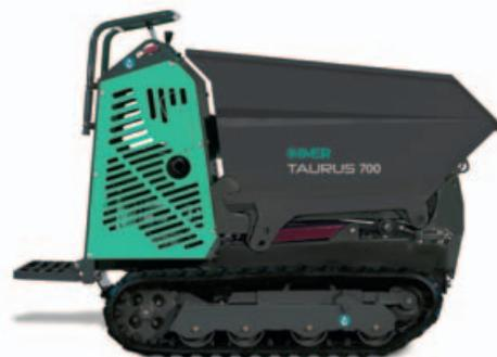
Motore a emissioni sonore ridotte e montato su antivibranti che riducono notevolmente le vibrazioni della macchina
