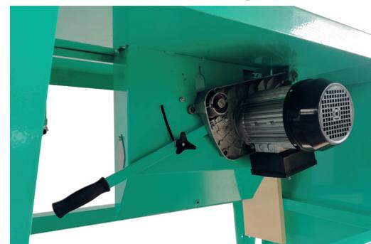
H110VR PLUS è dotata di leva per la regolazione dell'altezza di taglio da 0 a 110 mm.
