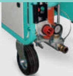
Flangia di mandata materiale in ghisa con misuratore di pressione. Connessione diretta per tubo DN35 F. Permette di estendere le tubazioni fino a 50 m con il minimo incremento delle pressioni di lavoro. La riduzione per applicare il tubo DN 25 è inclusa nell'equipaggiamento di serie.
