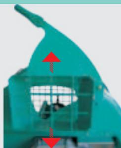
La griglia anti-intrusione è un elemento indispensabile e non deve essere un ostacolo al passaggio del materiale. IMER ha adottato un efficace sistema brevettato per scrollare manualmente il convogliatore all'occorrenza, liberando il passaggio del materiale. Utile soprattutto quando si utilizzano prodotti fibrorinforzati.
