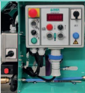
Pannello di comando con inverter e display interattivo.
